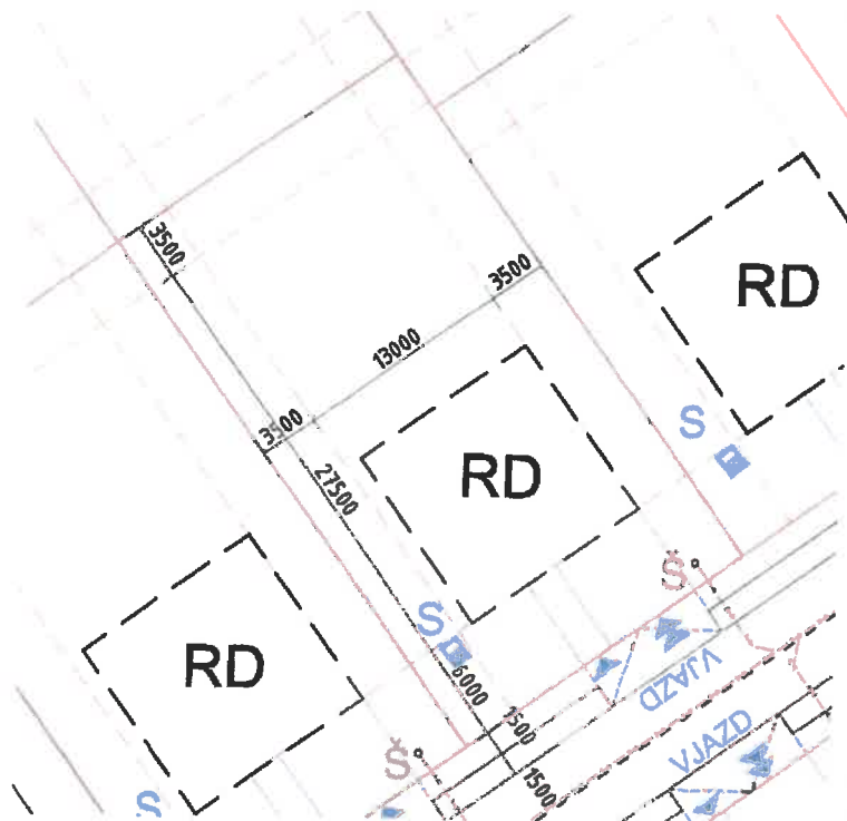
PRÍKLAD USPORIADANIA PARCELY, HRANÍC A ODSTUPOV
